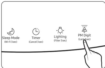
Sie können die aktuelle Luftqualität auf der Anzeigetafel mit der Farbe (welche PM10 / PM2.5 / PM1.0 / Gasverschmutzung darstellt) und der Konzentrationspegel-Anzeige anzeigen lassen.
