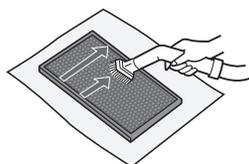
Entfernen Sie vorsichtig Staub mit einem Staubsaugeraufsatz oder einem ähnlichen Werkzeug vom HEPA-Filter.
