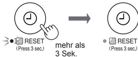
Die Filter-Reset-Anzeigeleuchte wird nach etwa 720 Betriebsstunden aktiviert.
