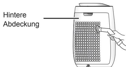
Entfernen Sie mit einer Staubsauger oder einem ähnlichen Werkzeug vorsichtig den Staub von der hinteren Abdeckung.
